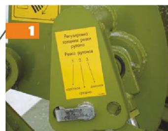
Толщину резки можно регулировать: 9-15-22 см (опционально 5-10-15)
