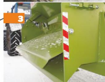
Дополнительный съемный лоток позволяет использовать резчик рулонов в хозяйствах, где установлены высокие кормушки.
