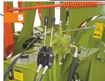
Независимая гидравлическая система исключает использование некачественного масла от гидросистемы трактора.
