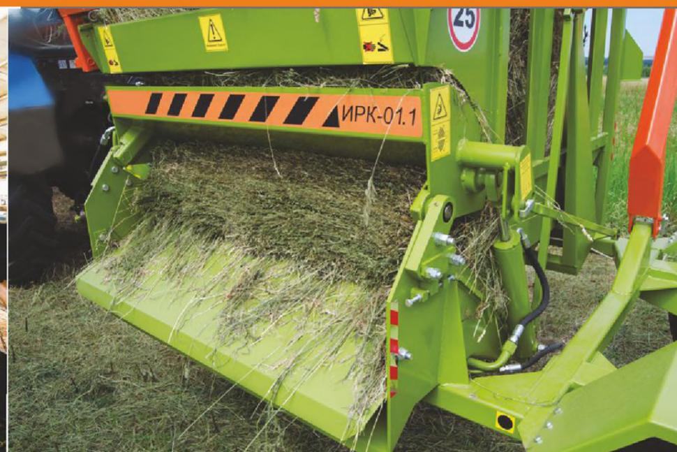
На ресурсных испытаниях резчик рулонов проходит 500 км. Производительность резчика 7-10 рулонов в час.
