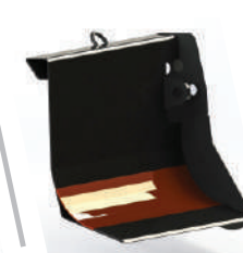
Коробчатое сечение основания «отвала»
